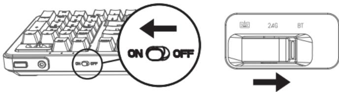
1. 打开电源开关至ON，旋转模式旋钮到BT模式, Num Lock指示灯闪三下后熄灭。
