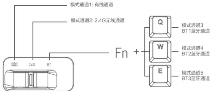
1、模式通道: 键盘有5个通道, BT1、BT2、BT3、2.4G、有线, 可同时连接5个设备。
