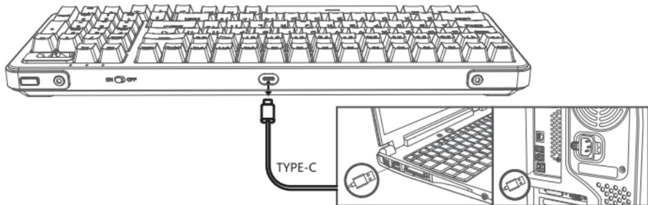
1. 充电线TYPE-C接口插入键盘，USB接口连接到您的电脑。
