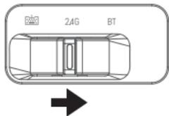
3. 旋转模式旋钮到2.4G模式,Num Lock指示灯闪两下后熄灭,切换成功完成连接。
