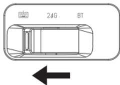
2. 保持模式旋钮指示在OFF,或旋转到
