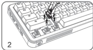
用拔轴器将轴体拔出。
