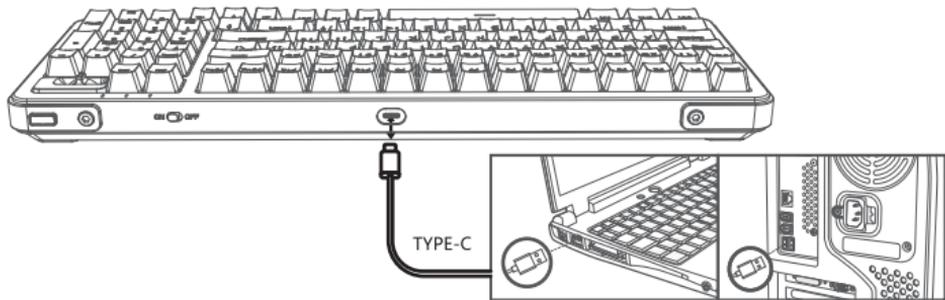
2. 充电线TYPE-C接口插入键盘, USB接口连接到您的电脑开始充电, 充电过程 灯红灯常亮。
